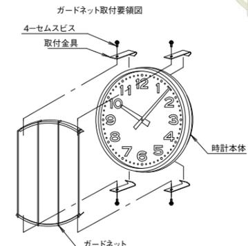
ガードネットは設置時にケースの加工をする必要がなく、ビス止めで取り付け可能です。
