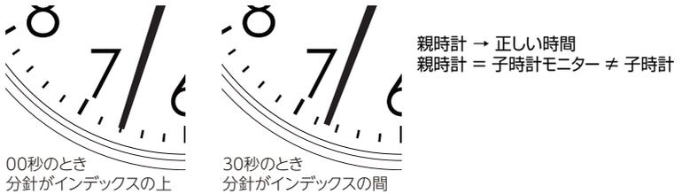
子時計の分針は00秒と30秒のいずれかの位置で停止します。子時計の針が指している時刻を良く見ていただき、00秒/30秒いずれかの設定をしてください。
