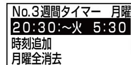
すべて設定して決定ボタンを押すと、設定の完了を示すブザー音が鳴り、設定したプログラムが表示されます。
