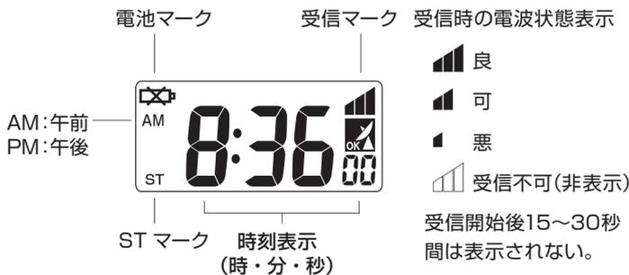
受信マーク: 受信に成功した場合点灯 受信時電波の強さにより変化。
