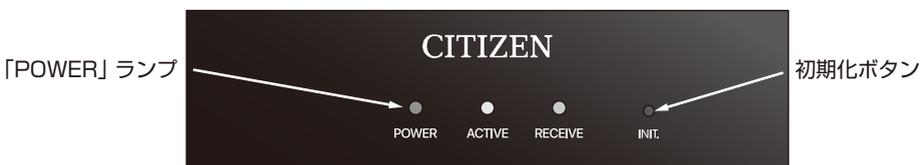
すべての配線を外した状態で、本体に AC アダプターを挿入して電源を投入します。次に初期化ボタンを先の細いマイナスドライバーや棒のようなものを使用して 3 秒以上押し続けます。「POWER」ランプが赤色と橙色の交互点灯に変わると初期化完了です。初期化ボタンをはなしてください。
